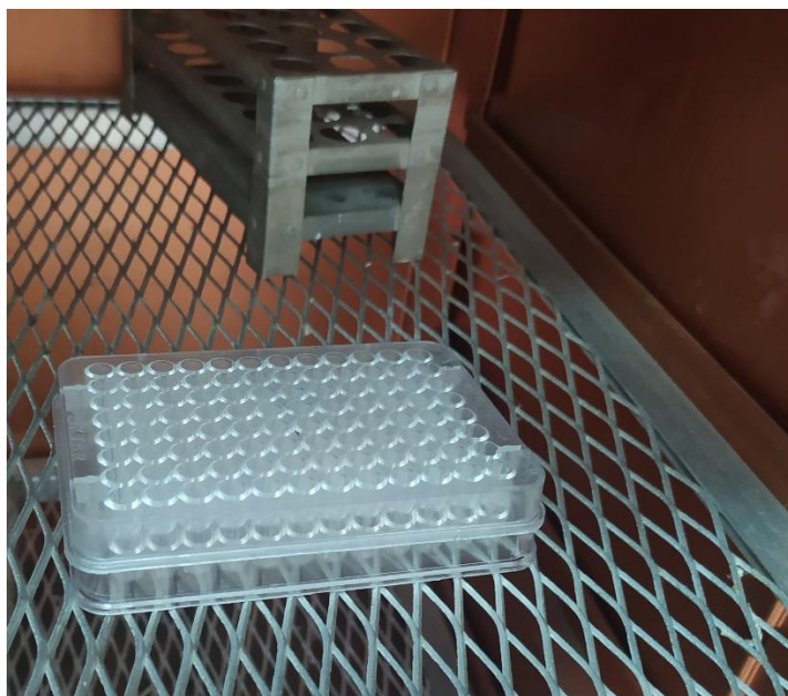
Слика 6. Инкубисање микротитар плоче у инкубатору на 37° С
