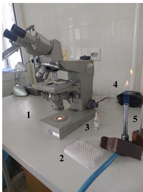
Слика 7. Приказ радног поља са микроскопом; 1 – микроскоп са тамним пољем, 2 – микротитар плоча, 3 – капалица са алкохолом, 4 – пламеник и 5 – еза
